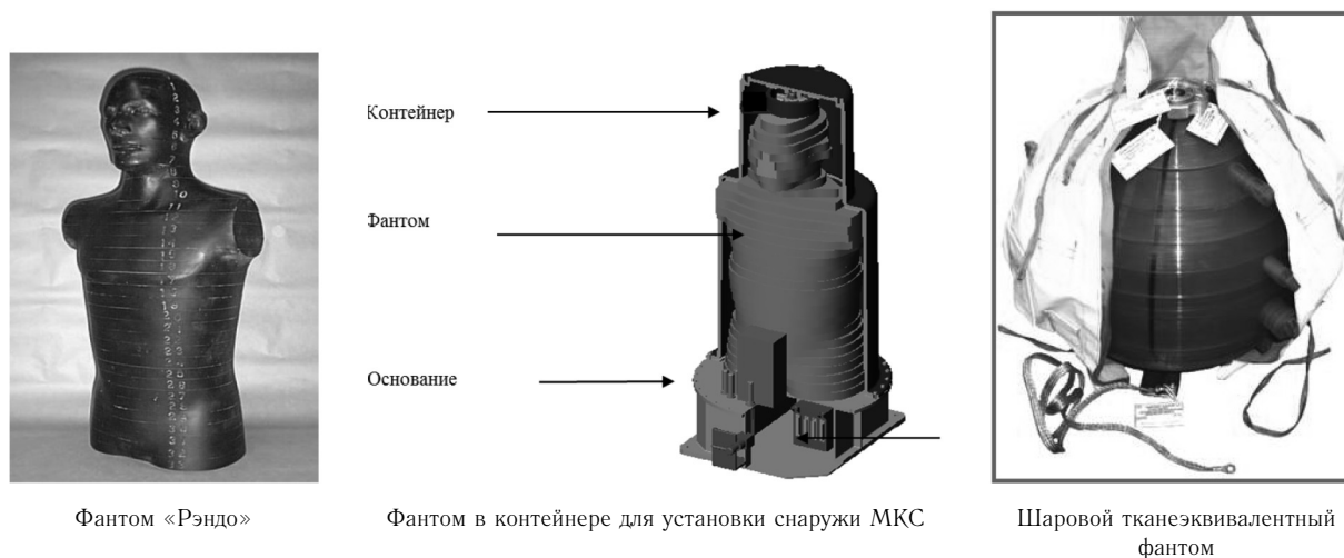
Рис. 2. Примеры тканеэквивалентных фантомов космического эксперимента «Матрешка-Р»
