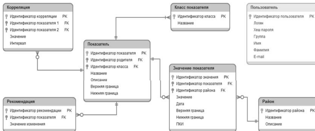
Рис. 2. Логическая схема базы данных для хранения статистической информации о социально-эколого-экономической ситуации в регионе
