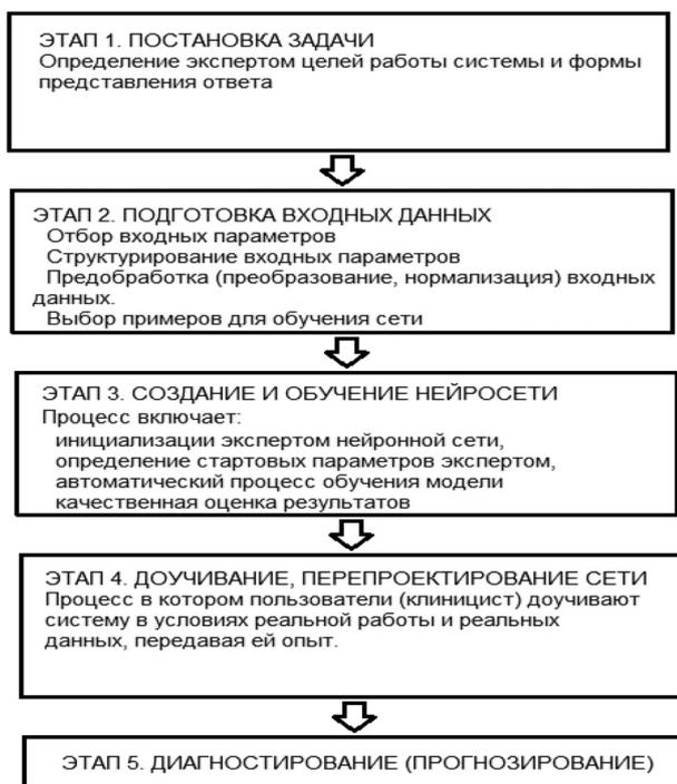
Рис. 2. Блок-схема методики построения нейросетевой модели
