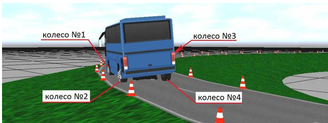
Рис. 6. Фрагмент виртуальных испытаний «вход в поворот»
