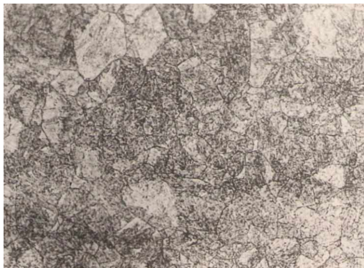
Рис. 1. Микроструктура стали в исходном (горячепрессованном) состоянии. Увеличение \times 340 S_{cp} 79-84 \text{мкм}^2
