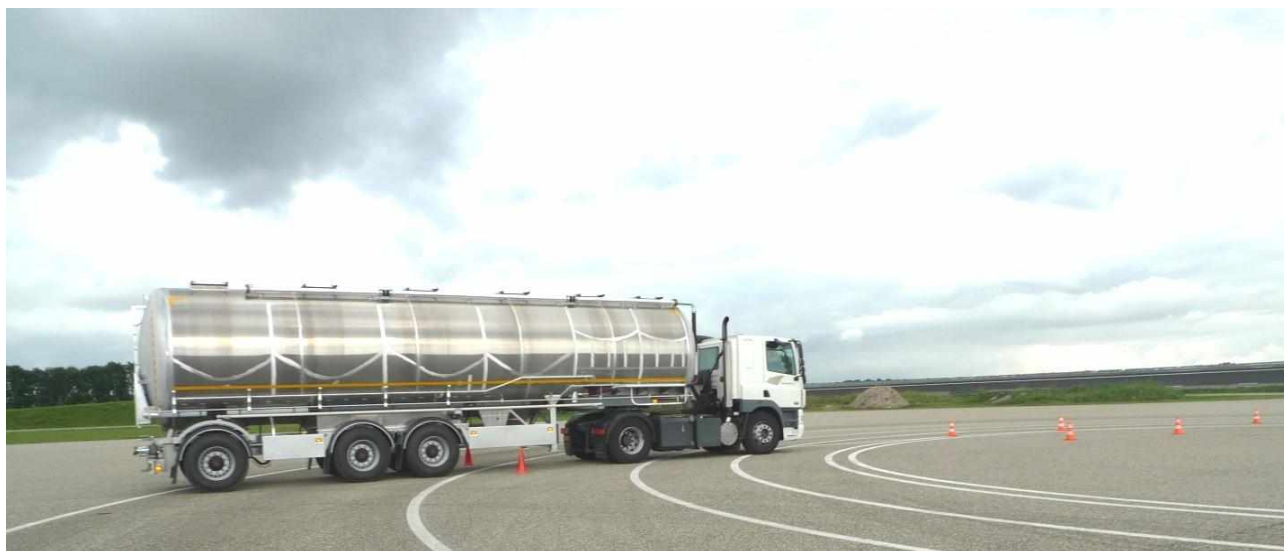
Рис. 10. Фрагмент дорожных испытаний «смена полосы движения (переставка)»
