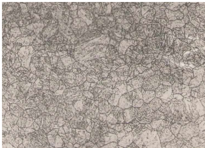
Рис. 3. Микроструктура стали после закалки с температуры 950 0 С и отпуска при температуре 610 0 С. Увеличение \times 340 S_{cp} 56 мкм 2
