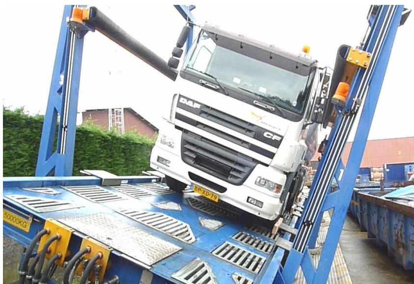
Рис. 7. Фрагмент натурных испытаний по оценке статической поперечной устойчивости
