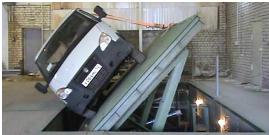
Рис. 2. Экспериментальные исследования статической устойчивости микроавтобуса
