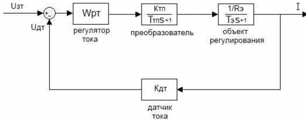
Рис. 2. Структурная схема контура тока ЭМП
