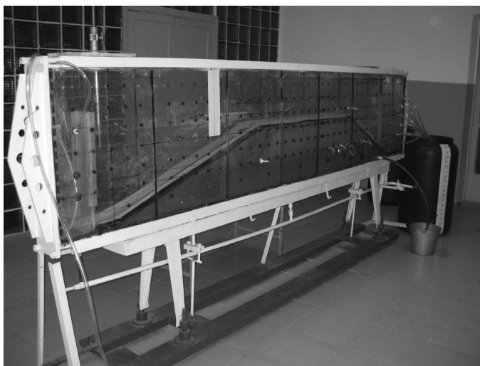
Рис. 1. Экспериментальная модель водослива с широким порогом
